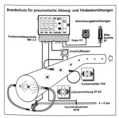
Bild 1: Funkenerkennungs- und Löschanlage
