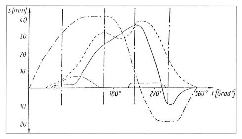
Abb. 1: Weg-Zeit-Diagramm des Stickbildungsprozesses — Fadenleiter I; — · · — Fadenleiter II — · · · · Schiffchen; — Nadel; — · · · · · Sperrzeug
