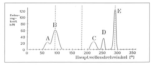
Abb. 2: Prinzipieller Fadenzugkraftverlauf bei einer Hauptwellenumdrehung
