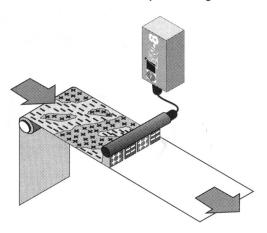
Durch die Beseitigung statischer Elektrizität bei der Verarbeitung von Textilien optimieren Sie den Produktionsablauf und senken die Kosten.
