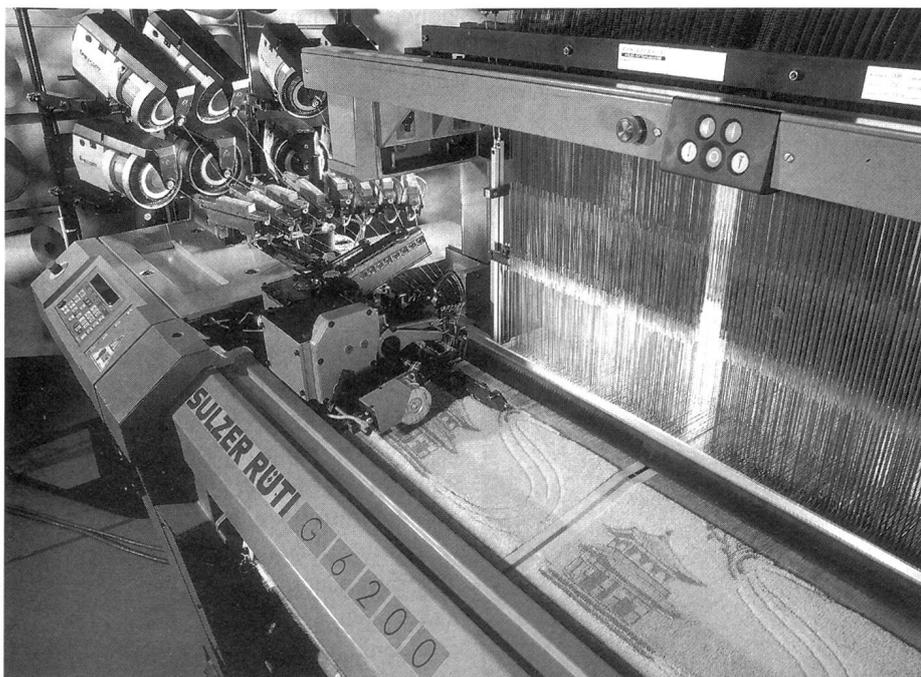
Bild 2: Frottiervwebmaschine mit der dynamischen Florsteuerung Foto: Sulzer-Rütli
