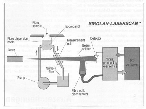
der einzelne Wert bestätigt, damit wird sichergestellt, dass nur einzelne Haare gemessen werden und nicht Büschel, genausowenig, wie Schmutz oder Faserfragmente.
