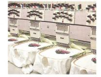
Sondereinrichtungen für Pailletten-, Bohr-, Kordel/Schlaufen Stickerei \* automatischer Fadenschneider sowie Ober- und Unterfadenwächter \* Steuerungstechnik mit Farbmonitor und Benutzerdialog in Landessprache
