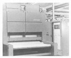
Flockenspeiser Exactafeed FBK 536 mit Vliesprofilregelung VPR.
