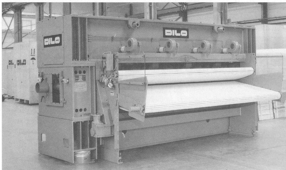
DILO-Doppelnadelmaschine DI-LOOM OUG-II/S mit Vlieszuführsystem CBF.
