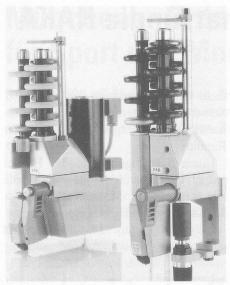
Die neue Friktionsaggregat-Generation FTS 52 von FAG gibt es als Einzelaggregat in Fixcenter- (Bild rechts) oder in Klappausführung (Bild links) jeweils umrüstbar auf Antriebe für Tangentialriemen oder mit Einzelmotor. Besonderer Vorteil der Klappausführung ist das sichere Fadeneinlegen bei der Verarbeitung von feinfilamentigen Garnen auch bei höchsten Fadenlaufgeschwindigkeiten. Bild: FAG
