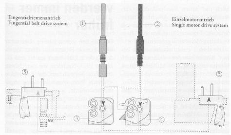
Durch den Austausch der Antriebslagerung mit Wirtel (1) in Lagerung mit Zahnriemenscheiben (2), können die FTS 52-Aggregat-Oberteile sowohl in Fixcenter-(3) als auch in Klappausführung (4) problemlos von Antrieben mit Tangentialriemen in Antriebe mit Einzelmotor umgerüstet werden. Bei beiden Antriebsarten wird der gleiche Support (5) mit integriertem OLT-Sensor eingesetzt. Bild: FAG
