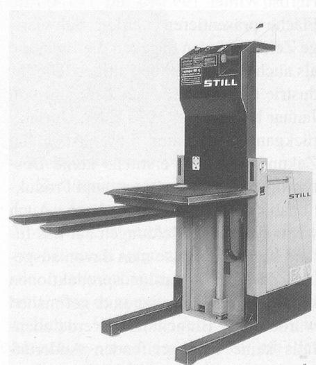
das Still-Kommissioniergerät, Modell EK 10. Dieses Gerät vereint maximalen Komfort und höchste Sicherheit. Die hohe Hub- und Fahrgeschwindigkeit ermöglicht ein zügiges Kommissionieren bis zur Greifhöhe von etwa 2,8 m.
