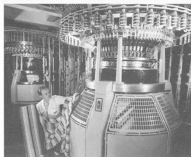
*Der Techniker im Bilde prüft eine Rolle feinen Wollstoffs, die auf einer dem neuesten Stand der Technik entsprechenden Wirkmaschine gefertigt wurde. Der buntgestreifte Stoff ist ebenso leicht und kühl wie Baumwolle oder Kunststoff und ein in jeder Hinsicht für Sommermoden geeignetes Material.*
