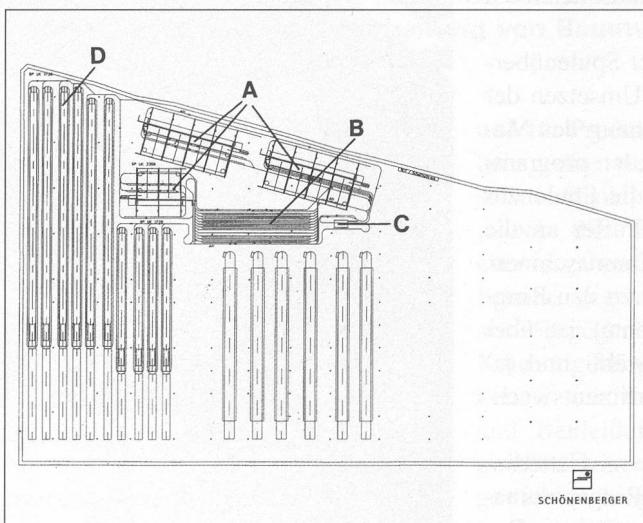
Trotz begrenzter, vorgegebener Raumverhältnisse: Das 2100 Meter lange, automatische Transportsystem Servotrail verbindet drei Flyer mit zehn Ringspinnmaschinen, ergänzt um einen zentralen Puffer und eine Hülsen-Reinigungsstation.
