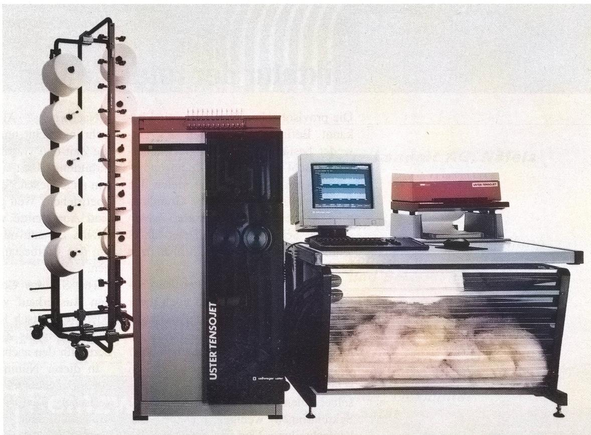
*Digitale Hochleistungs-Zugprüfanlage Uster Tensojet*
