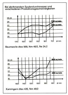
Verlauf der Fadenzugkraft mit und ohne Bandzugregulierung bei abnehmendem Spulendurchmesser und verschiedenen Produktionsgeschwindigkeiten.
