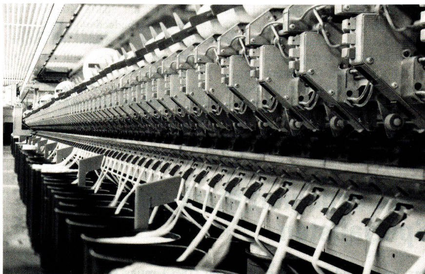
Rotorspinnmaschine. Bei der zur Jahresmitte 1991 übernommenen Schlafhorst-Gruppe konnte dank gezielter Restrukturierungsmassnahmen bereits nach wenigen Monaten eine Trendwende eingeleitet werden. Zusammen mit Schlafhorst ist die Saurer-Gruppe heute die weltweit bedeutendste Anbieterin von Spinnsystemen. Im Bild der Rotor-Spinnspulautomat Autocoro, wichtigster Umsatzträger der Schlafhorst-Gruppe.
