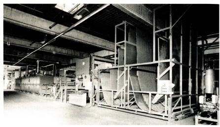
Die neue Teppichrückenbeschichtungsanlage bei Tellux.
