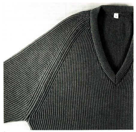
Die formgerecht gestrickten Einzelteile werden dann ohne Vorbügeln und Zuschnitt konfektioniert. Die Halseinfassung wird als Konfektionsgang auf der Kettelmaschine gekettelt.
