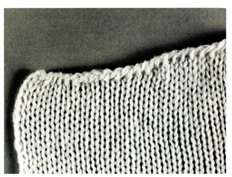
Die Flachstrickmaschine kettelt Formstrickteile ab, so dass diese rundum mit festen Kanten konfektionsfertig aus der Maschine kommen.
