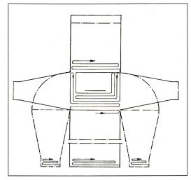
Beim Komplett-Pullover strickt die Maschine Vorderteil und die beiden Ärmel gleichzeitig. Vorderteil, Rücken und Ärmel können mustergemäss und farblich beliebig variiert werden.
