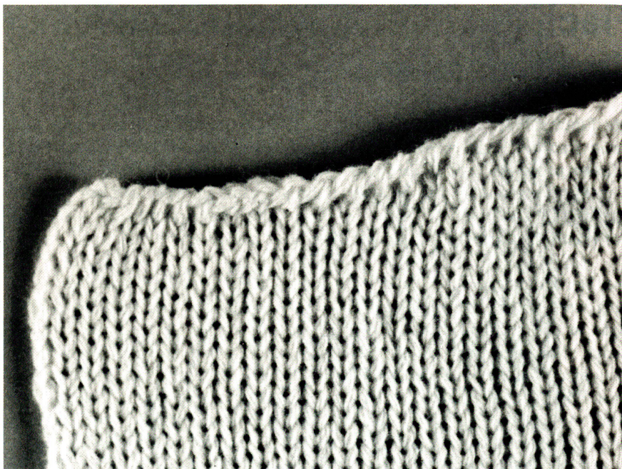
Die Flachstrickmaschine kettelt Formstrickteile ab, so dass diese rundum mit festen Kanten konfektionsfertig aus der Maschine kommen.
