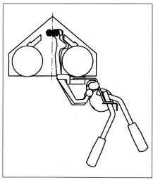
Schema für die Anordnung des Zusatz-Warenabzuges.
