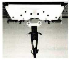
Intarsien-Fadenführerkasten mit Fadenführer.
