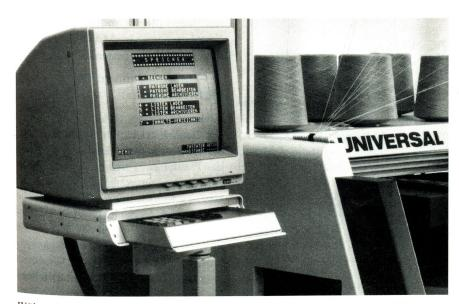
Während des Maschinenlaufes kann mit der Sonderausstattung I-MA-700 an der Maschinensteuerung das nächste Muster programmiert werden. Dies sogar für einen anderen Typ der Baureihe.
