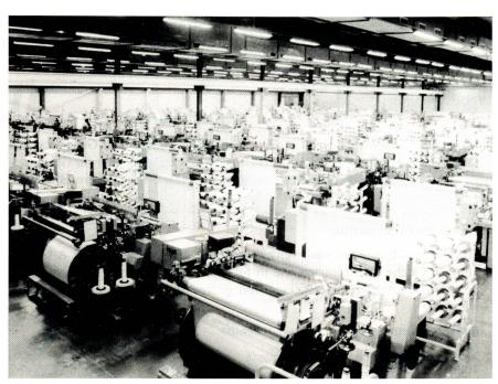
Webmaschinenanlage der Hexcel-Genin in Avenieres, Frankreich, mit Luftdüsenwebmaschinen des Typs L 5100 zur Herstellung feiner Glasfasergewebe.
