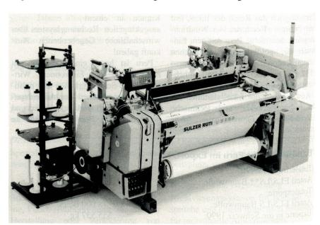
Luftdüsenwebmaschine L 5100 zur Herstellung von Glasgeweben; ausgerüstet mit automatischer Spulenwechselvorrichtung (links), Rotationsspeicher und Mischwechsler.
