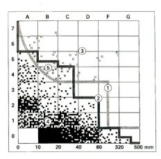
Bild 5: Opticlass Garnfehlerklassierung. Baumwolle gekämmt Ne 80, Verteilung der tolerierten Dickstellen und der störenden Garnfehler.
