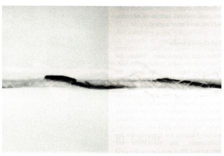
Bild 2: Jutefaser eingesponnen in ein Wollgarn Nm 18, Opticlass C2
