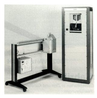
Spulenwechsler mit integriertem Mess-Lieferwerk für 50 oder 110 Fäden
