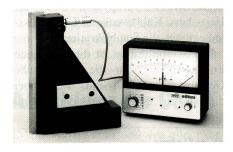
Der Messwinkel wird an das Werkstück herangeführt, damit sich die Messschneide an das Werkstück anlagen kann. Die Winkelabweichung des Werkstückes zur Auflagefläche kann direkt auf einer Messuhr oder einer elektronischen Messwertanzeige abgelesen werden.
