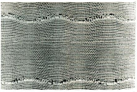
Wellenförmige Kettfäden sowie der Einsatz von Effektgarnen zeigen bewegte Strukturen.
