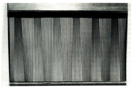
Spezialwebblatt mit fächerförmig angeordneten Rietstäben.
