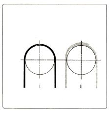
Die Endverbindung der Habasit Spindelbänder (I) bleibt im Gegensatz zu überlappenden Klebfolien- und Nähverbindungen (II) hochflexibel. Daraus resultiert ein schlagfreier, die Spindellager schonender Lauf. Eine extrem hohe Lebensdauer wird damit begünstigt.
