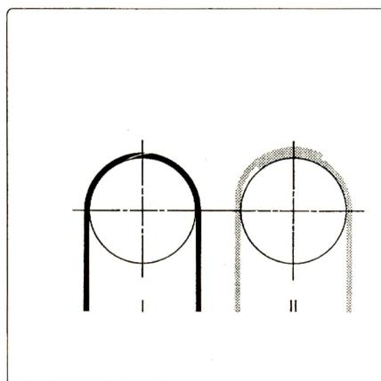
Die Endverbindung der Habasit Spindelbänder (I) bleibt im Gegensatz zu überlappenden Klebefolien- und Näherbindungen (II) hochflexibel. Daraus resultiert ein schlagfreier, die Spindellager schonender Lauf. Eine extrem hohe Lebensdauer wird damit begünstigt.
