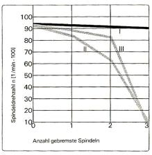
Beim Bremsen einer oder mehrerer Spindeln werden die Drehzahlen der Nachbarspindeln nur unbedeutend beeinflusst. Die Wärmebeständigkeit der Wirtelseite ergibt hohe Lebensdauer.
