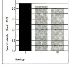
Vergleichstests dokumentieren die dank idealem Reibwert höheren und gleichmässigeren Spindeldrehzahlen mit Habasit (I) gegenüber gewöhnlichen Nylon- (II) und Baumwoll-Spindelbändern (III).
