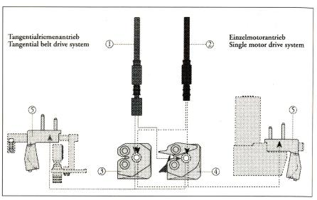
Durch den Austausch der Antriebslagerung mit Wirtel (1) in Lagerung mit Zahnriemenscheiben (2) können die FTS 52-Aggregat-Oberteile sowohl in Fixcenter-(3) als auch in Klappausführung (4), problemlos von Antrieben mit Tangentialriemen in Antriebe mit Einzelmotor umgerüstet werden. Bei beiden Antriebsarten wird der gleiche Support (5) mit integriertem OLT-Sensor eingesetzt. Foto: FAG
