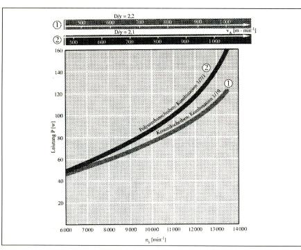
Leistungsbedarf P[w] des FTS 52-Aggregates als Funktion der Scheibendrehzahl  $n_s$  [ $min^{-1}$ ] und der Fadenabzugsgeschwindigkeit  $V_A$  [ $m \cdot min^{-1}$ ]
