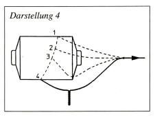
Schematische Darstellung der Krangelbildung, während dem Garnabzug von einer Spule bei tiefer Geschwindigkeit.
