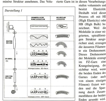
Schematische Darstellung des FZ-Prozesses mit geometrischer und molekularer Struktur eines einzeln texturierten Filamentes in verschiedenen Prozessstufen.
