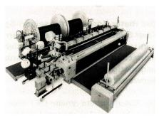
Sulzer Rüti-Projektilwebmaschine mit Schussmischer, zweibahnig belegt mit einem Denim, ausgerüstet mit Exzentermaschine, Motor-Kettablass Grob, automatische Schuss-Suchvorrichtung, automatische Fach-Hebevorrichtung, Webkettenspanner, Schussspeicher TMT, separater Kettbaumanordnung und Dockenwickler Grob.
