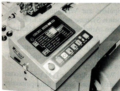
190 cm breite Sulzer Rüti-Luftdüsenwebmaschine des Typs L 5200 mit zentraler Mikroprozessorsteuerung. Dem bedienungsfreundlichen Touch Screen Terminal können vorprogrammierte Artikeldaten per Memory Card übermittelt werden.
