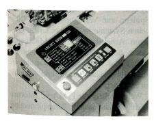
190 cm breite Sulzer Rüti-Luftdüsenwebmaschine des Typs L 5200 mit zentraler Mikroprozessorsteuerung. Dem bedienungsfreundlichen Touch Screen Terminal können vorprogrammierte Artikeldaten per Memory Card übermittelt werden.
