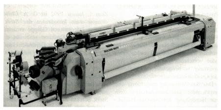
Sulzer Rüti-Vierfarben-Projektilwebmaschine mit zentraler Mikroprozessorsteuerung.
