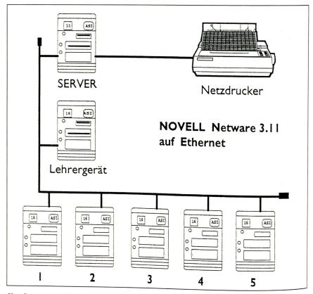
Konfigurationsschema des PPS-Trainings-System an der STF
