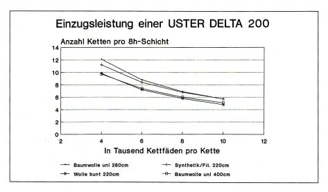
Die Graphik bezieht sich auf die Anzahl Ketten, die von Uster Delta 200 in einer 8-Stunden-Schicht, basierend auf der Anzahl Fäden in der Kette, eingezogen werden können. In diesem Zusammenhang wird davon ausgegangen, dass die einzuziehenden Webketten lückenlos bereitgestellt werden, so dass Unterbrüche beim Kettwechsel ausgeschlossen sind. Ferner nimmt man
