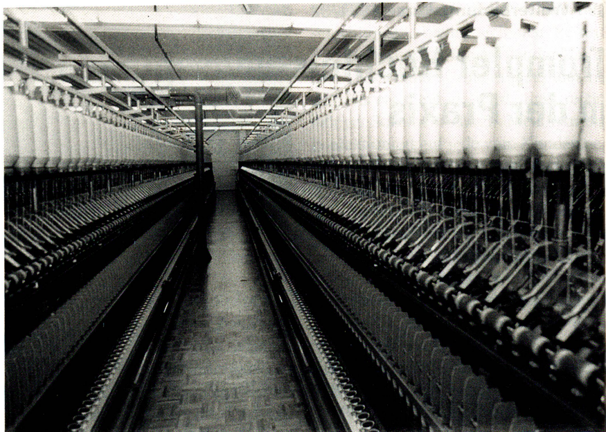
10 000 Spindeln mit Geschwindigkeiten von bis 21 000 Touren umfasst die neue Hi-Per-Spin-Anlage der Trümpler AG.
