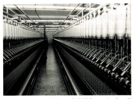
10 000 Spindeln mit Geschwindigkeiten von bis 21 000 Touren umfasst die neu Hi-Per-Spin-Anlage der Trümpler AG. Bild: mittex
