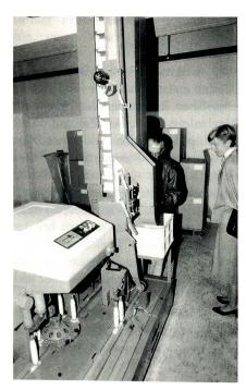
Vollautomatisch erfolgt die Zulieferung der leeren Hülsen und der Abtransport der vollen Kopse über zwei Ebenen.
