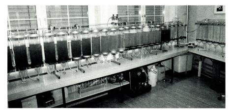
Modell der Schlichteprüfung in der EMPA St. Gallen. In diesen Behältern wird der Abbauprozess während 28 Tagen verfolgt. Bild: mittex
