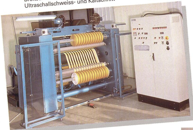
Kaltschneidmaschine Type GTE -
