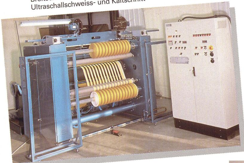
Kaltschneidmaschine Type GTE -
