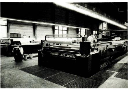
Die neuen automatischen Tisch-Flachfilmdruckmaschinen mit rotierendem Druckband.
