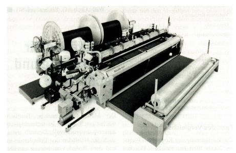
Sulzer Rüti Projektilwebmaschine P 7100 B 360 N 1-1 EP R D 1 mit Schussmischer, zweibahnig mit einem Denim belegt, ausgerüstet mit Exzentermaschine, «GROB Jumbo Let-off System», autom. Schusssuchvorrichtung, autom. Fachhebevorrichtung und «Grob-Grossdockenwickler» mit einem Dockendurchmesser von 1500 mm. Kettbaumanordnung von Webmaschine getrennt. Kettbaumscheiben «Scholze», Scheibendurchmesser 1500 mm.
