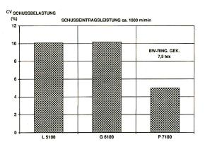
Abb 7: Vergleich von Variationskoeffizienten der Schussfadenbelastung
