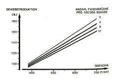
Abb. 2: Produktionszunahme in Funktion der Drehzahl
