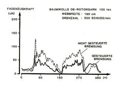
Abb 9: Schussfaden-Zugkraftverlauf (Webzyklus) Bandgreifer-Webmaschine
