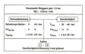
Abb 8: Dominanz der Garnfestigkeits-Streuung Projektil-Webmaschine
