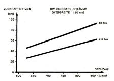
Abb. 4: Schussfaden-Spitzenkraft in Abhängigkeit von der Drehzahl (Luftdüsen-Webmaschine)
