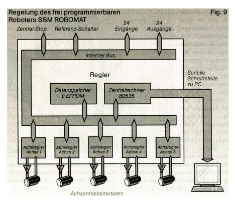
Beschleunigung werden von einem Geschwindigkeitsprofilgenerator zusammen mit der vorgegebenen Zielposition dazu benutzt, um die notwendigen Beschleunigungs- und Bremsrampen sowie die maximale Verfahrgeschwindigkeit zu berechnen. Während einer Bewegung vergleicht das Lageregel IC periodisch die vom Profilgenerator berechnete Position mit der aktuellen Position und bestimmt unter Berücksichtigung der PID Regelparameter das entsprechend notwendige Ausgangssignal für die Motorendstufe.
