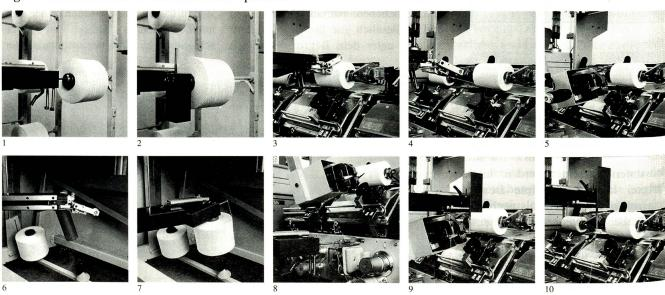
(10.). Darauf wird die Spulstelle automatisch neu gestartet. Der Robomat fährt zurück an die Quelle, deponiert die leere Vorlagehülse und wartet auf die nächste Aufforderung zum Spulenwechsel.
