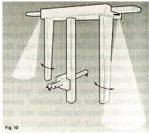
trennt werden. Der Robomat wird dadurch innerhalb weniger Zentimeter Weg gestoppt. In der Folge muss dann das System neu gestartet werden.
