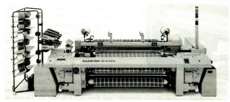
1992: Sulzer Rüti Greiferwebmaschine G 6200 der neunten Generation
