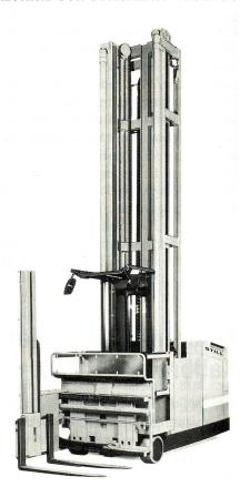
Geschwindigkeiten für Vor- und Rückwärtsfahrt und hydraulische Bewegungen gesteuert. Gelenkt wird über den Sterngriff; die Lenkstellung für Geradeausfahrt wird angezeigt.
