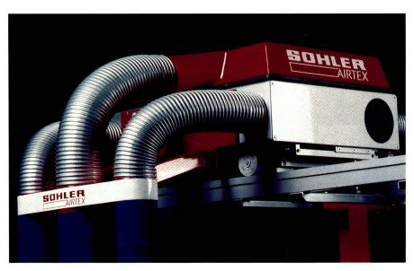
Das Gerät kann im Baukastenprinzip wahlweise mit Lüftermotoren von 1,5 bis 3,0 kW ausgerüstet werden. Es entleert am Maschinenende vollautomatisch in eine zentrale Abfallentsorgung. Die Energiezufuhr erfolgt entweder über Stromschienen oder alternativ über Energiekette.
