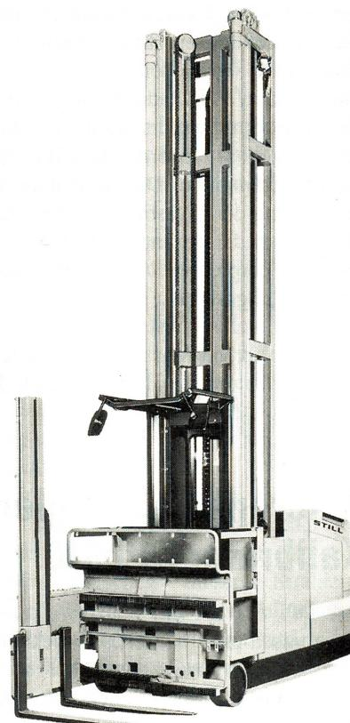
Geschwindigkeiten für Vor- und Rückwärtsfahrt und hydraulische Bewegungen gesteuert. Gelenkt wird über den Sterngriff; die Lenkstellung für Geraudeausfahrt wird angezeigt.
