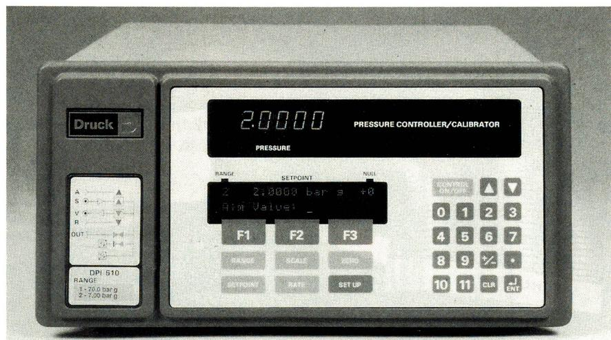
Hilfe einer digitalen Fehlerkorrektur wird die hervorragende Kalibriergenauigkeit von 0,04% vom Messwert erreicht. Zudem kann der Anwender, falls erforderlich, das DPI 510 selber nachkalibrieren. Dafür ist serienmäßig ein leicht zu handhabendes Kalibrierprogramm eingebaut.
