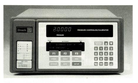
Hilfe einer digitalen Fehlerkorrektur wird die hervorragende Kalibriergenauigkeit von 0,04% vom Messwert erreicht. Zudem kann der Anwender, falls erforderlich, das DPI 510 selber nachkalibrieren. Dafür ist serienmässig ein leicht zu handhabendes Kalibrierprogramm eingebaut.
