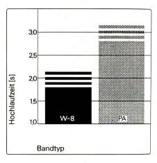
Abb. 2: Minimierte Hochlaufzeit durch verbessertes Adhäsionsverhalten
