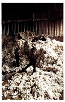
Dies ist kein Schnee: Von Hand wird die Rohbaumwolle der Entkörnung zugeführt.
