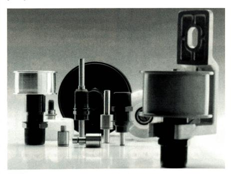
FAG Komponenten wie Zapfenlager, Rollenzapfen und Laufrollen sind besonders leichtgängige einbaufertige Einheiten. Montiert mit Laufmänteln aus Stahl, Kunststoff, Aluminium oder mit spezieller Beschichtung dienen sie zum Leiten, Führen und Spannen von Riemen und Bändern im Textilmaschinen- und allgemeinen Maschinenbau.
