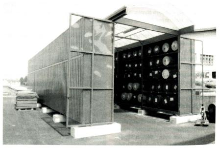
Systemcontainer-Anlage zur Lagerung von wassergefährdenden, brennbaren Stoffen.
