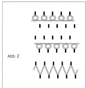
Für alle I 3Ps stehen eine Vielzahl von Wechselexzentern zur Verfügung, die allen stricktechnischen Erfordernissen entsprechen, unabhängig ob extrem leichte oder sehr schwere Einstellungen der Warengewichte gefragt sind. Rippränder mit Elastomergarnen auf je einer Nadelbahn (Abb. 1) lassen sich ebenso herstellen wie 2-Seiten-Ware auf produktivster Bindungsbasis (Abb. 2) aktuell für Freizeit-/Sportbekleidung und technische Artikel.
