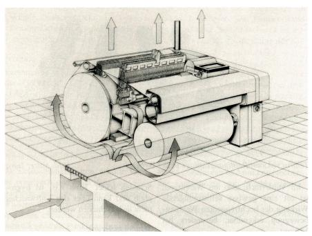
Condifil Arbeitszonenklimatisierung für Webmaschinen
