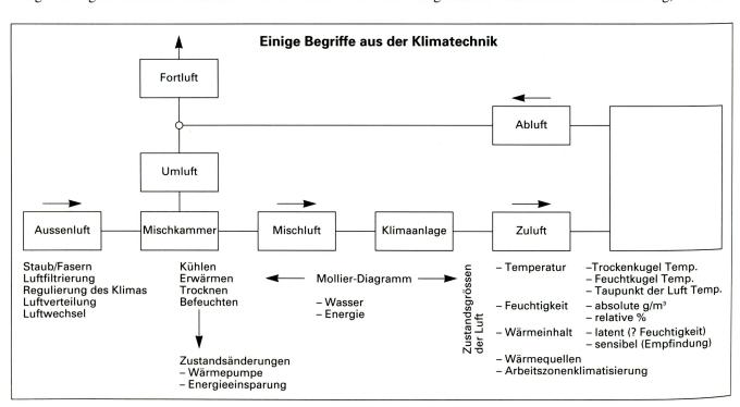
halpiedifferenz zwischen Zuluft und Raumluft sowie dem Luftmassenstrom. Der Luftmassenstrom ist direkt proportional der Wärmeleistung im Raum und umgekehrt proportional der Enthalpiedifferenz.
