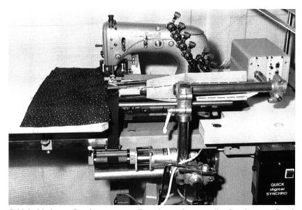
Bild 3: Moderner Bundautomat mit Einrichtung für partielles Rüschen von Bundgummi.
