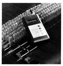
Messzelle mit Picatens Kettspannungsmessgerät. Bild: Picanol N. V.
